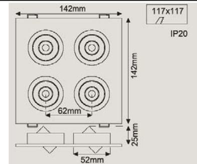
Sistema integrado para montagem no teto
